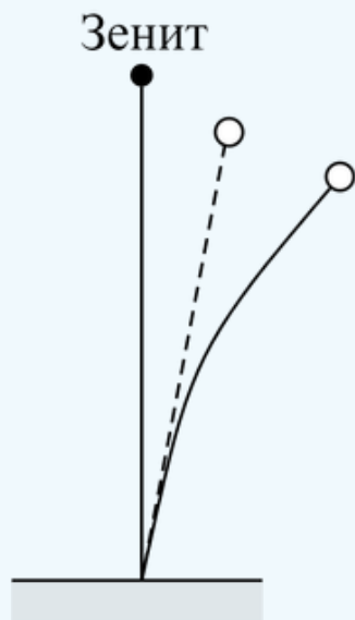
Рис. 3. Криволинейное распространение светового луча в атмосфере (сплошная линия) и кажущееся смещение объекта (пунктирная линия)
